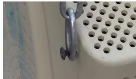
Рис. 8 Цепь можно перекинуть на одно или два звена, тогда она станет короче
