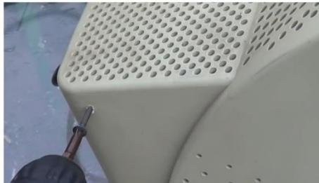
Рис. 7 Вкручиваем саморезы в корпус монитора – они будут служить крепёжными крюками
