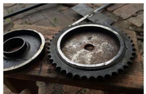
**6** На следующем этапе звездочку приваривают к валу. Далее из листовой стали толщиной 2-3 мм создают и устанавливают на место лопаты шнека. Для этого вырезают окружность шириной 100-120 мм. Ее разрезают пополам. Отдельные ленты растягивают от звезды до лопатки, прикрепляют сварными соединениями.
