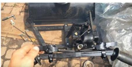
**19** Далее завершают монтажные операции. Устанавливают желоб, проверяют его функциональность. Для возврата верхней части в нижнее положение закрепляют пружину. Окрашивают внешние поверхности.
