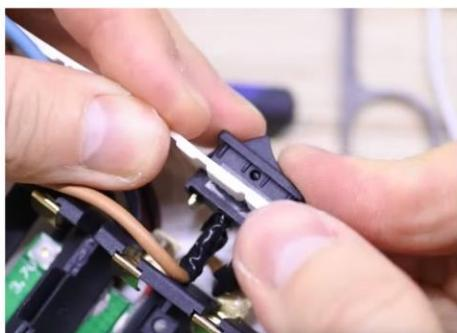
**19** Расставляем другие компоненты на корпусе. Индикатор можно закрепить горячим kleem.
