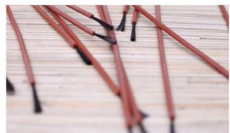
**26** Далее провод. Его зачищаем с краю, и далее делаем несколько голых секций под скрутку под шнур. Расстояние между оголёнными участками примерно 8 см.
