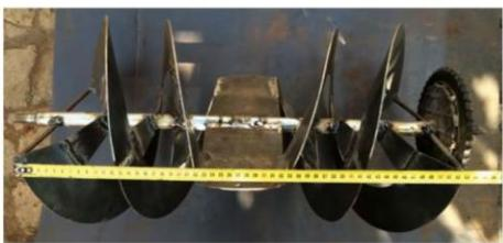
**8** Для создания отдельных элементов ковша можно применить стальной лист 1-1,5 мм. При такой толщине обеспечивается достаточная прочность, но не нужны чрезмерные усилия для создания изделия сложной формы.
