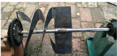
**7** Такую же конструкцию монтируют на второй части. Общая ширина рабочего захвата в этом проекте получилась 53 см.
