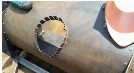
**11** Желоб – из стального листа (0,75-1 мм). Для его поворачивания в нужном направлении автор применил временное решение, круг с прорезями из оргстекла. В дальнейшем будет выполнена замена на аналогичную деталь из металла. Верхняя часть закреплена на шарнире. Она поворачивается верх и вниз для изменения траектории и дальности выброса. Силовая часть каркаса изготовлена из стального квадрата 20x40. Рукоятки – 20x20.
