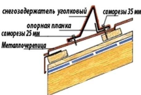
Снегозадержатели устанавливаются по скатам кровли параллельно карнизу, а также обязательно над мансардными окнами, с целью сохранения их функциональности. Принцип его действия – порционное пропускание снега и наледи между кровлей и трубками. Снегозадержатели устанавливаются либо в одну линию – «стык в стык», либо в шахматном порядке, на длинных скатах следует устанавливать снегозадержатели в несколько рядов.
