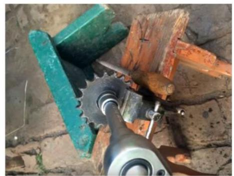
**14** Подготовленную деталь устанавливают на вал двигателя вместо штатной шестерни.
