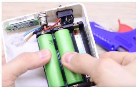
**21** Подсоединяясь наш аккумуляторный блок будет с помощью клемм.
