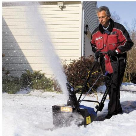
Эти агрегаты относятся к категории ручных, то есть, в их комплектацию не входит двигатель. Человек просто толкает аппарат, от колес которого до шнека проведена цепная передача. Она и является движущей силой. Чем быстрее толкает человек тележку, тем интенсивнее аппарат работает.
